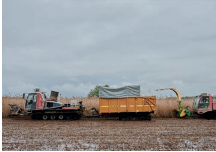
En slättermaskin på en modifierad pistmaskin blåser krossad vass på flaket av en annan maskin. Bild: Ilkka Vuorinen
