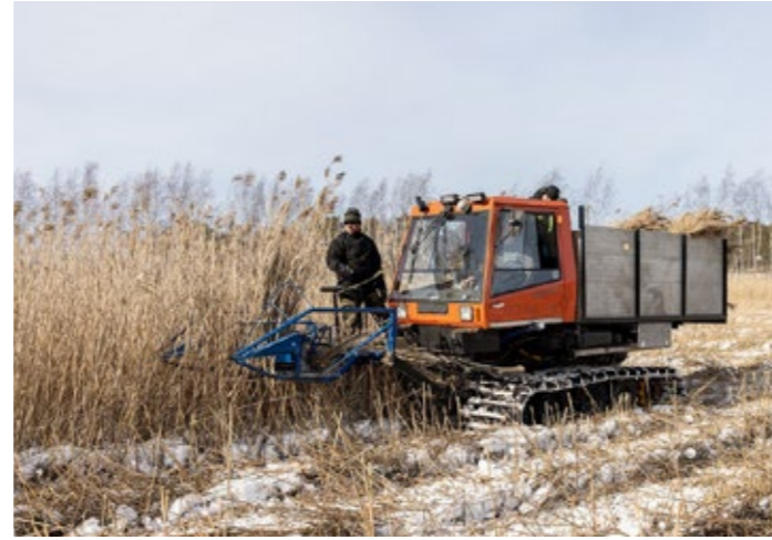
Rinnekonepohjainen niputtava talviniittokone. Kuva: Noora Norokytö.
