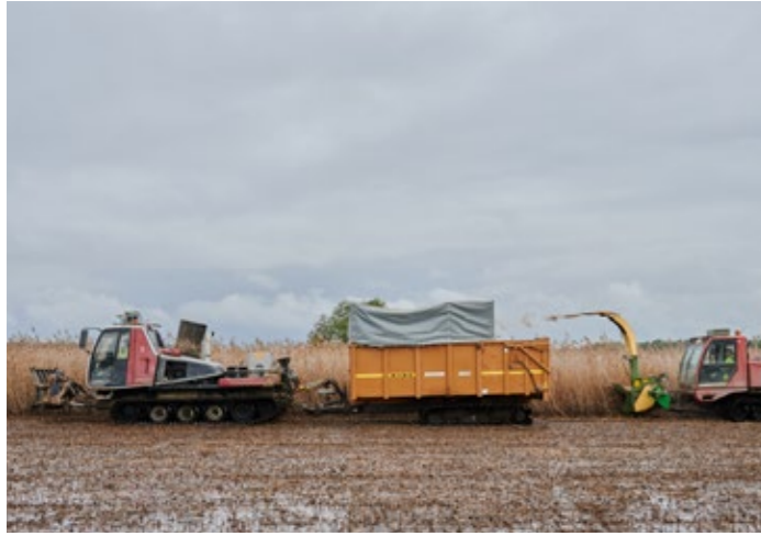
Rinnekonepohjainen niittokone puhalttaa niitetyn ruokomurskan toisen koneen perässä olevalle kuormalavalle. Kuva: Ilkka Vuorinen
