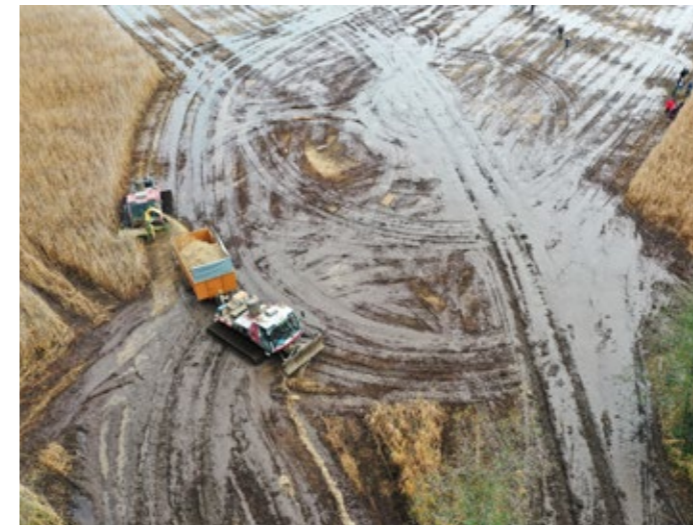
Niitto ja ruo'on keruu vaativat runsaasti ajokertoja raskailla koneilla, mikä kuluttaa pehmeää maapohjaa. Kuva: Tero Pajukallio
